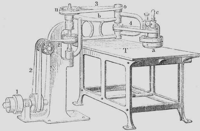
Abb 1: Frühe Schleifmaschine mit Transmissionsantrieb
